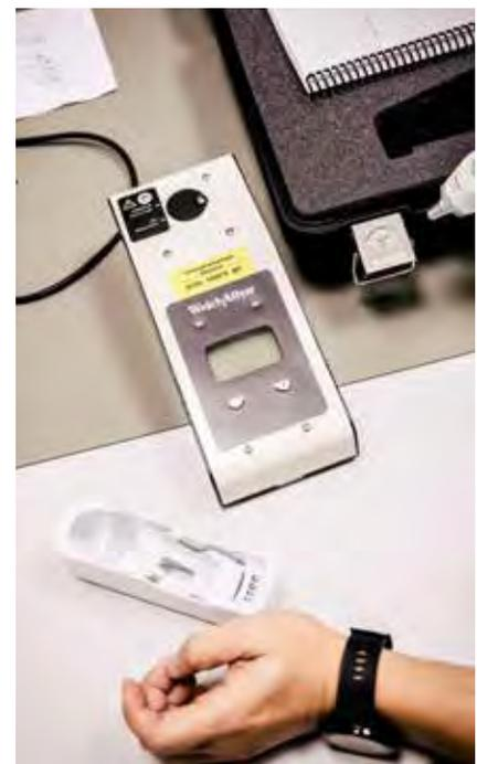
Prüfergerät für Ohrthermometer zur Durchführung der messtechnischen Kontrolle (MTK)
